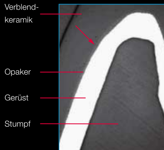
Opakerbrand bei 980 °C – zeigt einen deutlich besseren Haftverbund
