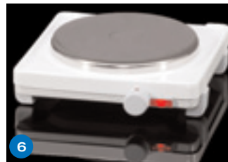
6 Temperaturindikator aufbringen und Modell auf die Heizplatte (Heizplatte benötigt 20 min. Vorwärmzeit; Stufe 3, nicht höher; Hitzebeständige Schutzschuhe tragen) stellen, bis sich der Indikator schwarz färbt. Nach der Entnahme von der Heizplatte direkt mit dem Auftragen des Basismaterials beginnen.
