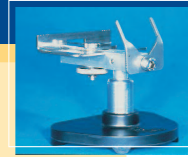
Detailansicht des OK-Modellpositionierers zum Einrichten des OK-Modells in den PROTAR-Artikulator
